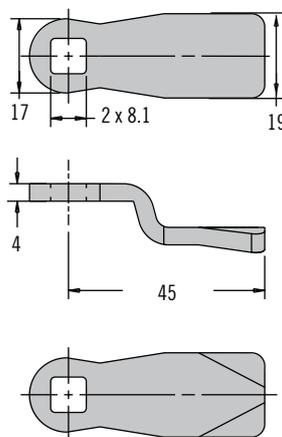
Per le versioni con serratura DIN è necessario rimuovere materiale, mentre è facoltativo farlo per gli altri tipi di serrature.
